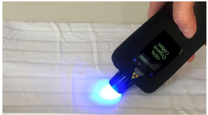
*Die Firma Tailorlux aus Münster entwickelt, gefördert durch die DBU, ein Markierungsverfahren für Bio-Baumwolle, bei dem die Fasern bereits in der Mühle so markiert werden sollen, dass sie später mit einem Spektrometer wiedererkannt werden können. So soll die Echtheit der Biobaumwolle garantiert werden. Ein weiteres DBU-Projekt testet eine Rückverfolgungsmethode ohne Markierung. Bild: Tailorlux*
